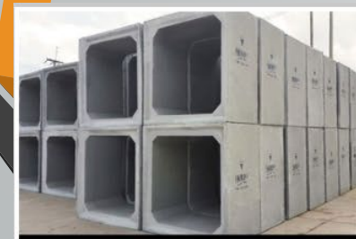
RC.Box ท่อระบายน้ำคอนกรีต
