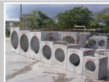
Manhole บ่อพักท่อระบายน้ำ
